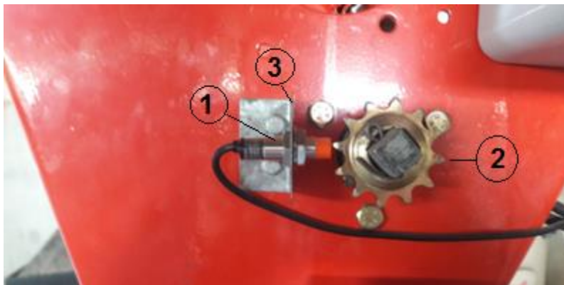
شکل ۳: مجموعه حسگر سرعت پیشروی شامل ۱- حسگر، ۲- چرخ زنجیر و ۳- پایه حسگر
